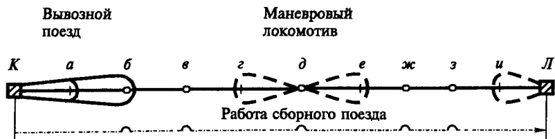
Рис. 70. Схема обслуживания станций поездами
