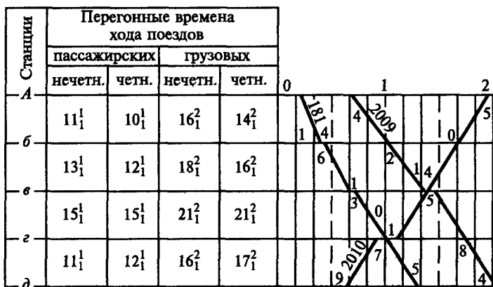
Рис. 77. Фрагмент нанесения ниток поездов на графике движения
